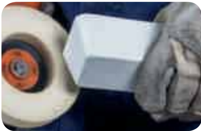
Οι FLS με τους φτερωτούς κετσέδες εγγυούνται την ιδανική διανομή της πάστας στίλβωσης
