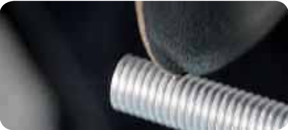
Κοπή ράβδων με σπείρωμα (βίδες), χωρίς γρέζια
